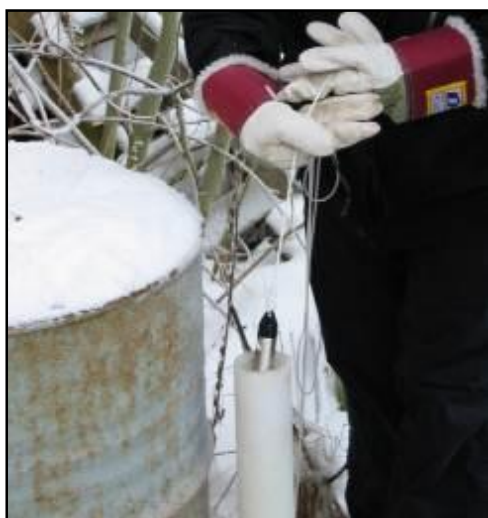
Bild 1 Diver i grundvattenrör
