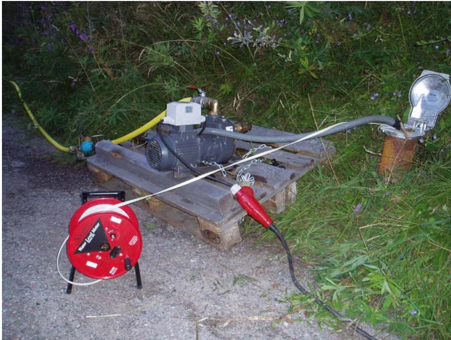
Figur 4. Vid pumpningen användes en sugpump, nivåer övervakades förutom med tryckgivare med logger även manuellt med ljuslod.
