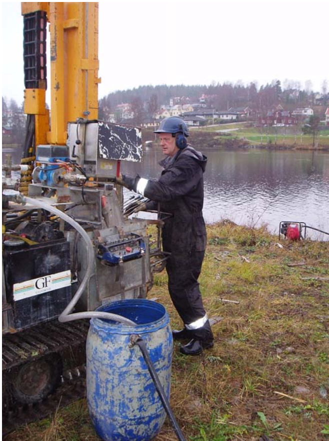
Figur 2. Geoteknisk undersökning vid Bengtsbrohöljen i EKA-området. Vid undersökningen användes en Geotek vagn av modell 506.
