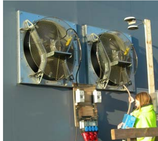
Figur 1. Miljökontrollant Annelie Loberg, Bengtsfors Kommun, mäter Hg 0 koncentrationen i utgående renad luft.
