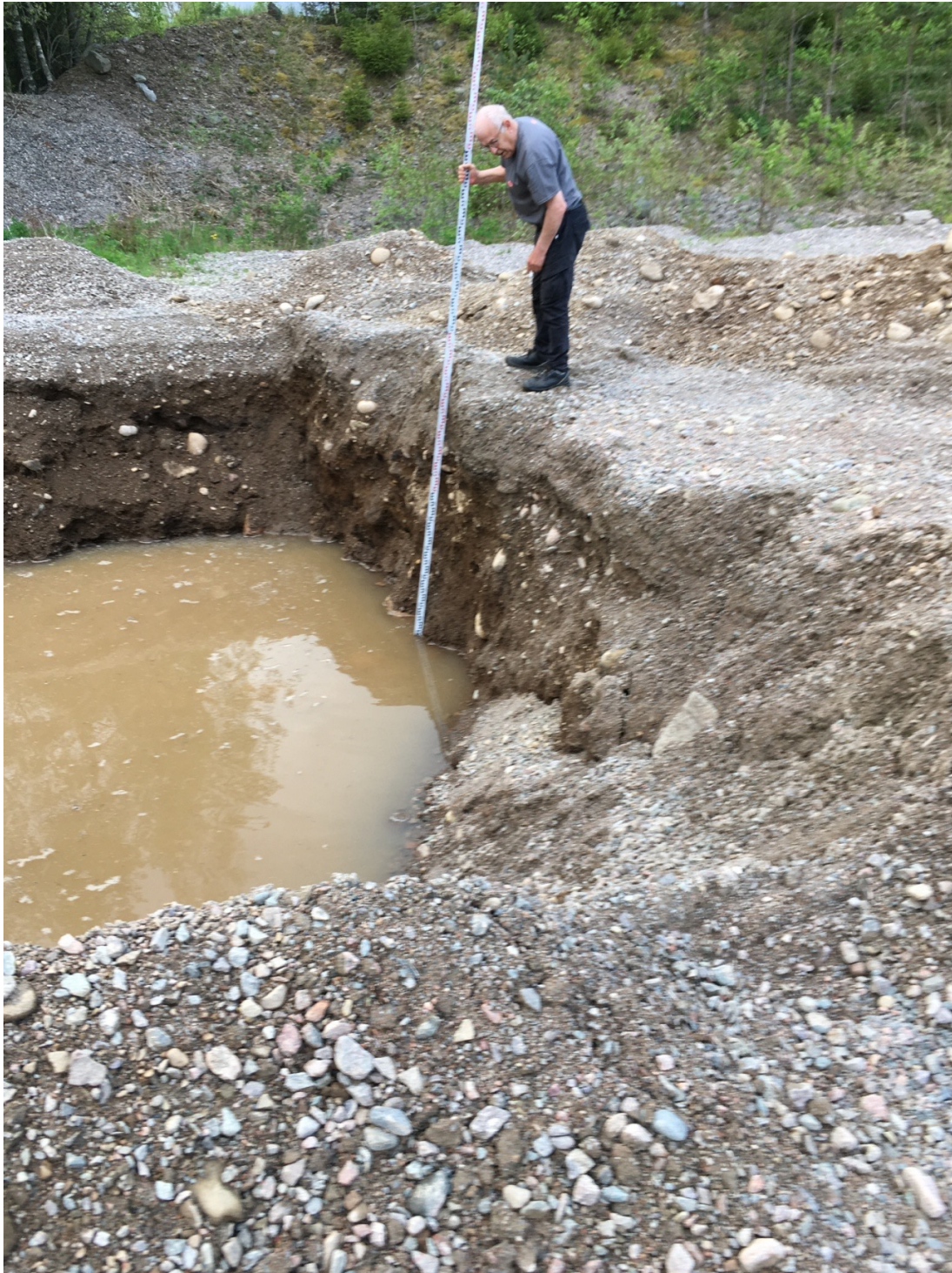
Fig. 2. Mätning i provgrop 7 den 2019-05-21. Notera frånvaron av skiktning i markmaterialet samt att grovt material typiskt utgör mindre sten, med endast enstaka undantag i form av större sten. Block saknas. Den materialvariation som syns i den borte schaktväggen är tydligen sekundär, och har uppkommit genom att marken jämnats ut.
