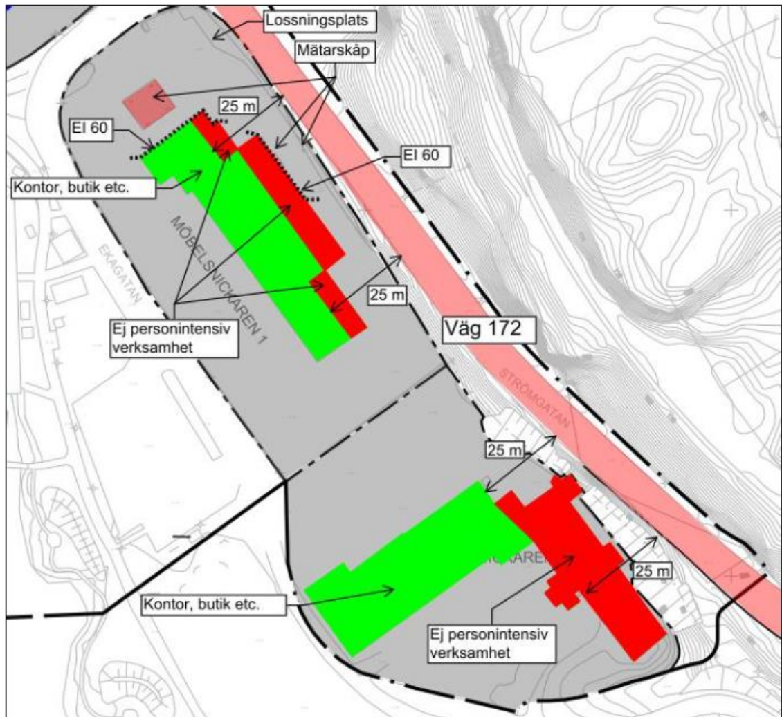
Riskkällor och riskreducerande åtgärder vid Möbelsnickaren 1 och 2, Detaljerad riskbedömning rev. 2016-01-20.
